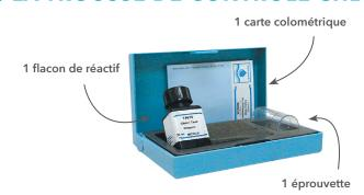
Le principe consiste à ajouter 4 gouttes de réactif dans les 5 ml d'eau contenus dans l'éprouvette et comparer la couleur obtenue avec celles de la carte colométrique. Le résultat doit être inférieur ou égal à 0,3 mg à l'arrivée du point de consommation.
